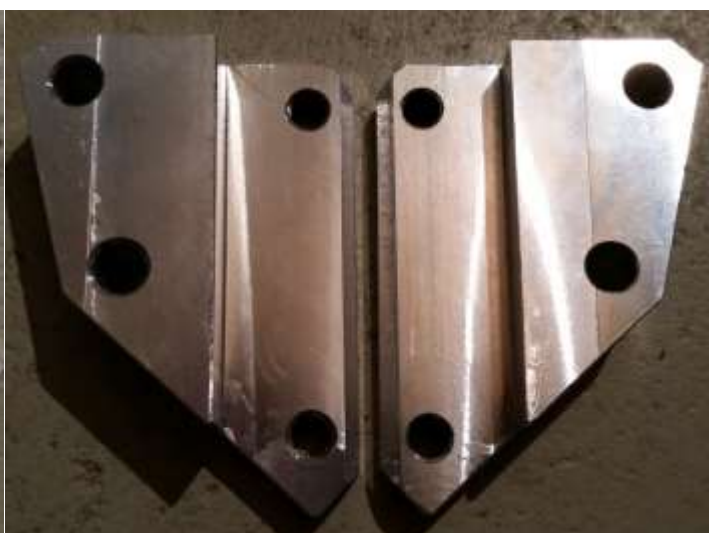
Abbildung 21: Bremssatteladapter (Rückseite)
