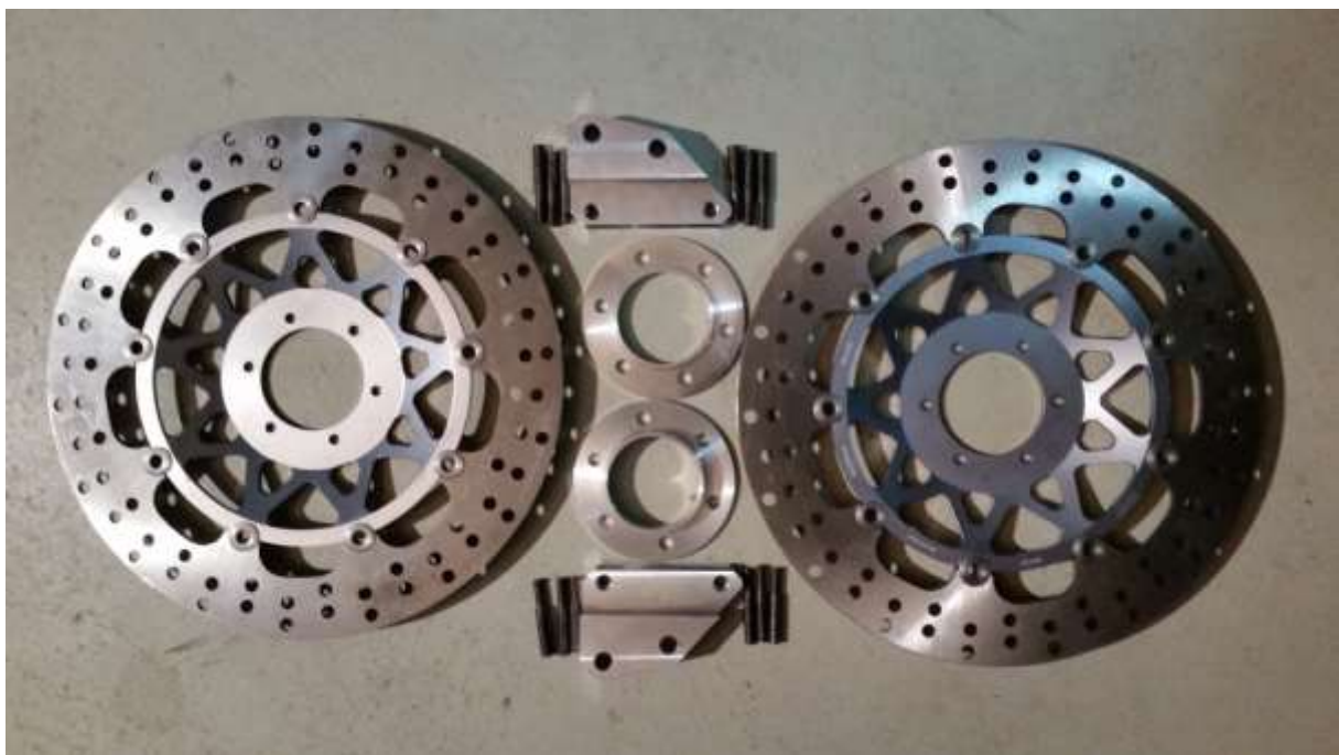
Abbildung 23: Bremsscheiben, Distanzringe, Bremssatteladapter, Schrauben links/rechts
