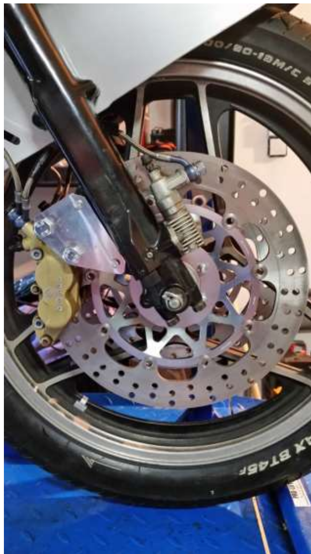
Abbildung 25: Bremsscheibe, Bremssattel-Adapter und Brembo-Bremssattel
