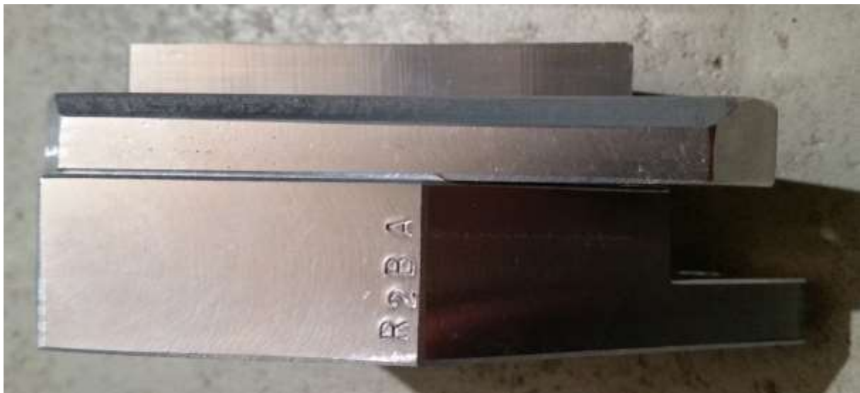
Abbildung 22: Bremssatteladapter links und rechts (R2BA)
