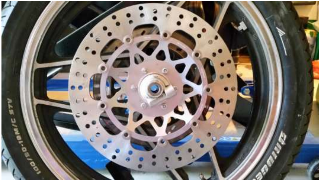
Abbildung 24: Bremsscheibe am Rad inkl. Distanzscheibe und Tachoschnecke
