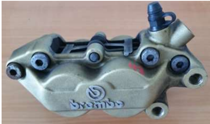
Abbildung 11: 4-Kolben Brembo Bremssattel einer Ducati 916 Biposto
